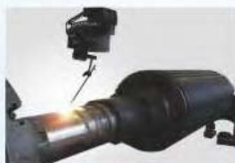
发电机转子轴颈激光修复
