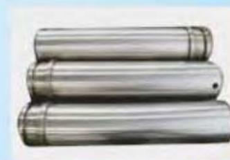
矿用大型液压支架立柱激光熔覆加工后
