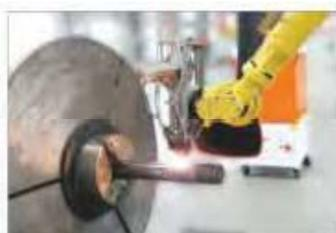
电机轴激光熔覆
