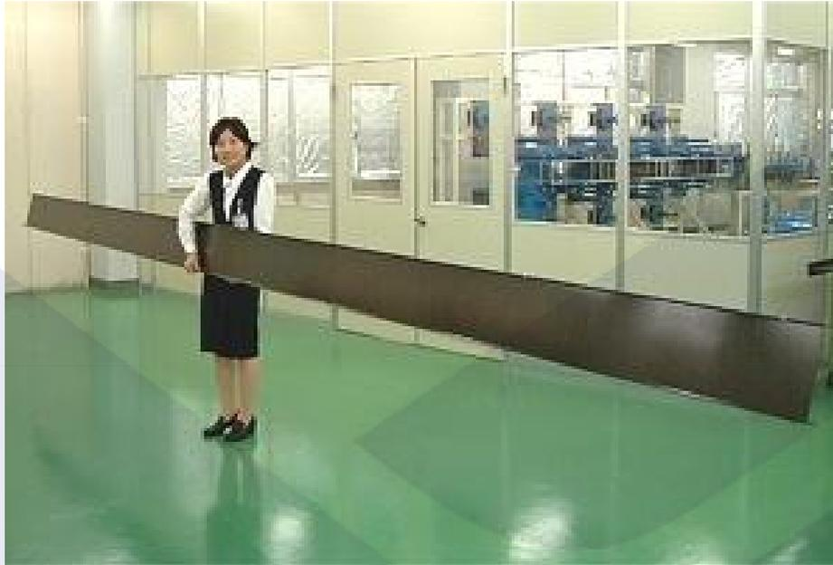
√ 应用于地板梁和加筋壁板的筋条成型
