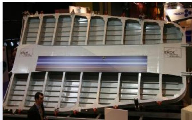
VARI 运输机货舱门 (A400M)
