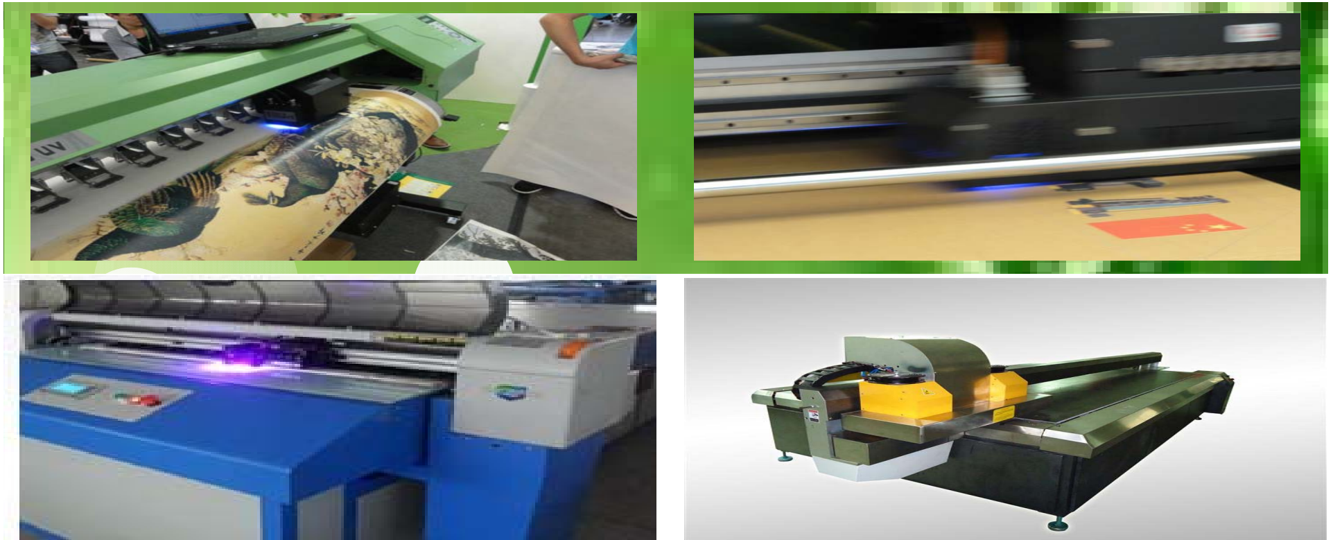
图17. 大幅面数码喷绘机及其 LED-UV 面光源光固化系统
