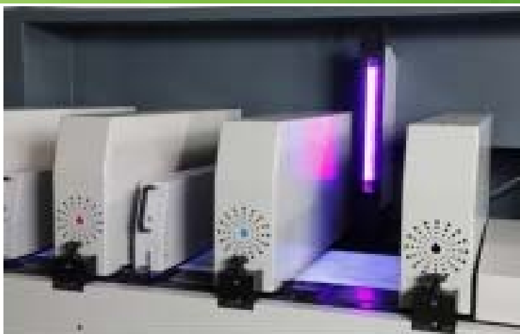
图 19. 平台式六色凸版印刷机及其 LED-UV 面光源光固化系统
