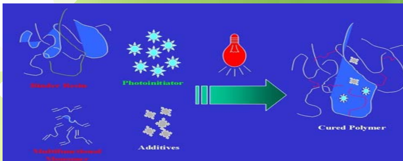
图5：UV固化原理示意图
