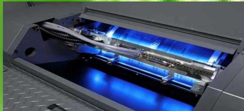
图14. LED-UV 六色胶印机（6+1）及其 LED-UV 面光源光固化系统
