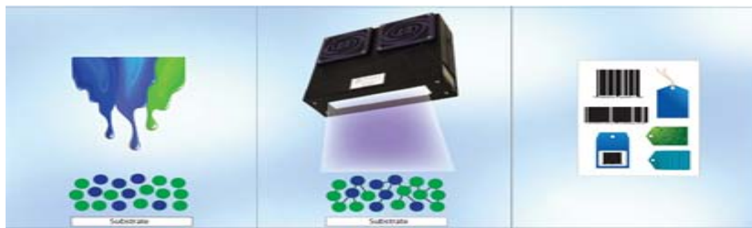
图8：LED-UV 固化原理示意图
