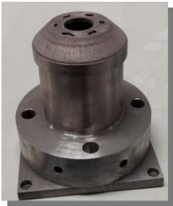
机加工与SLM结合成形
