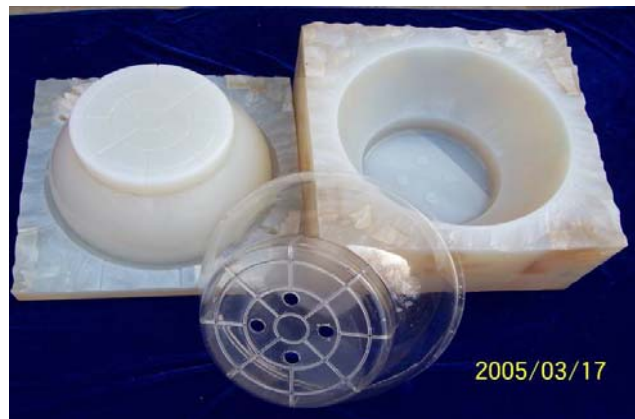
用 SLS 原型制作的硅橡胶模具
