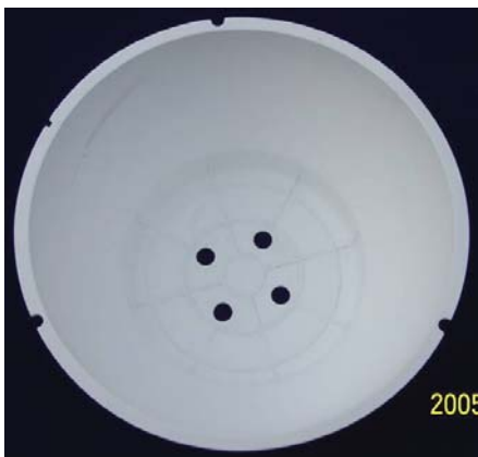
高分子粉末SLS快速制作的医疗头罩塑料原型 零件尺寸： 385.9 \times 385.9 \times 195.0 立方毫米
