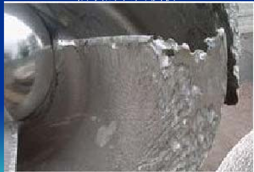
泵叶片磨损损伤
