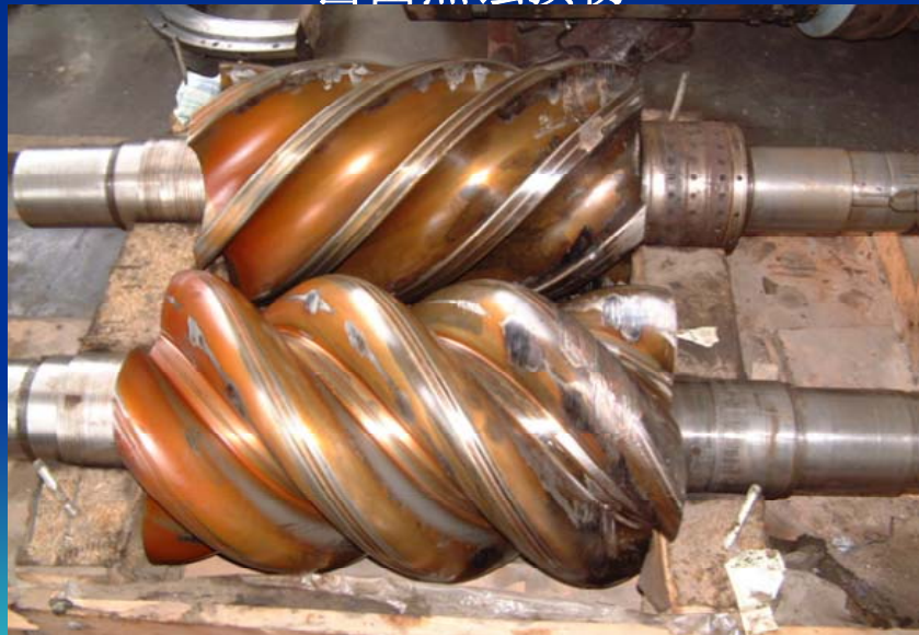
压缩机螺杆损伤
