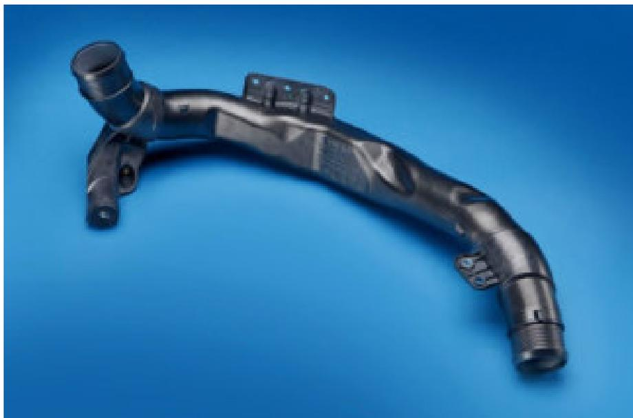
注射/吹塑成型玻纤增强PPS冷却管
