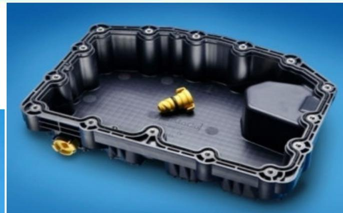
抗石击塑料油底壳,采用玻纤增强改性尼龙PA6。取代冲压件减重2.1磅成本下降30%。
