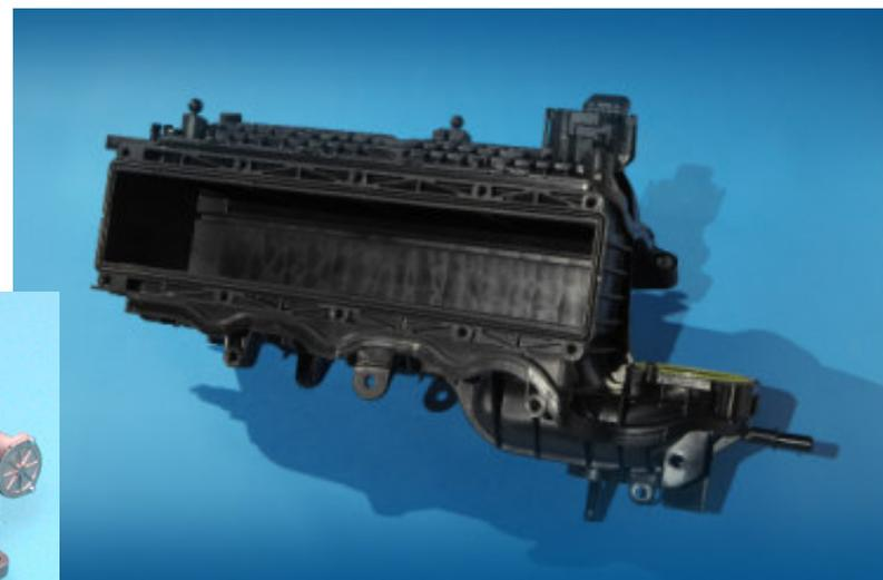
带冷却水套的进气歧管 采用玻纤增强尼龙PA6。减重25%。直接成本和间接成本分别降低30%和50%
