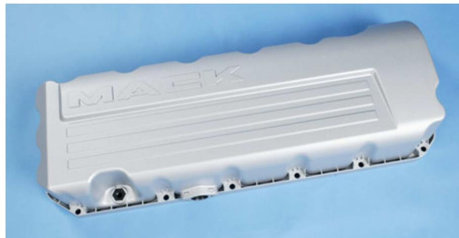
具有集油功能的塑料气阀室罩盖 采用SMC压模成型。较铝合金减重30%，成本下降50%。
