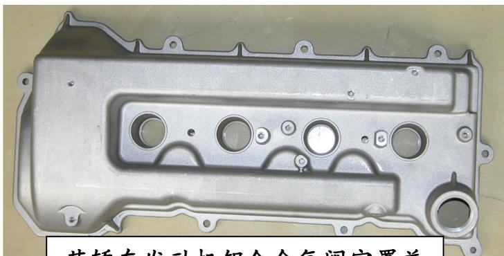
某轿车发动机铝合金气阀室罩盖
