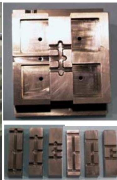
注塑成型可视化研究实验装置
