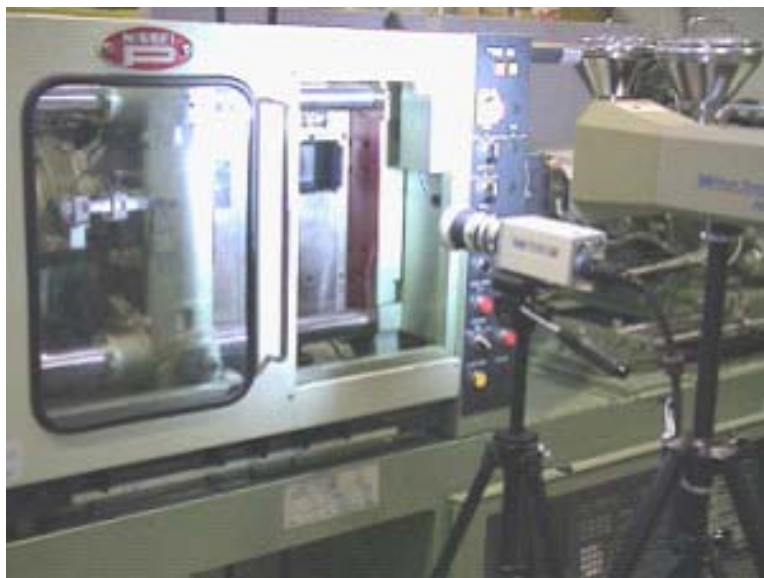
注塑成型可视化研究实验装置
