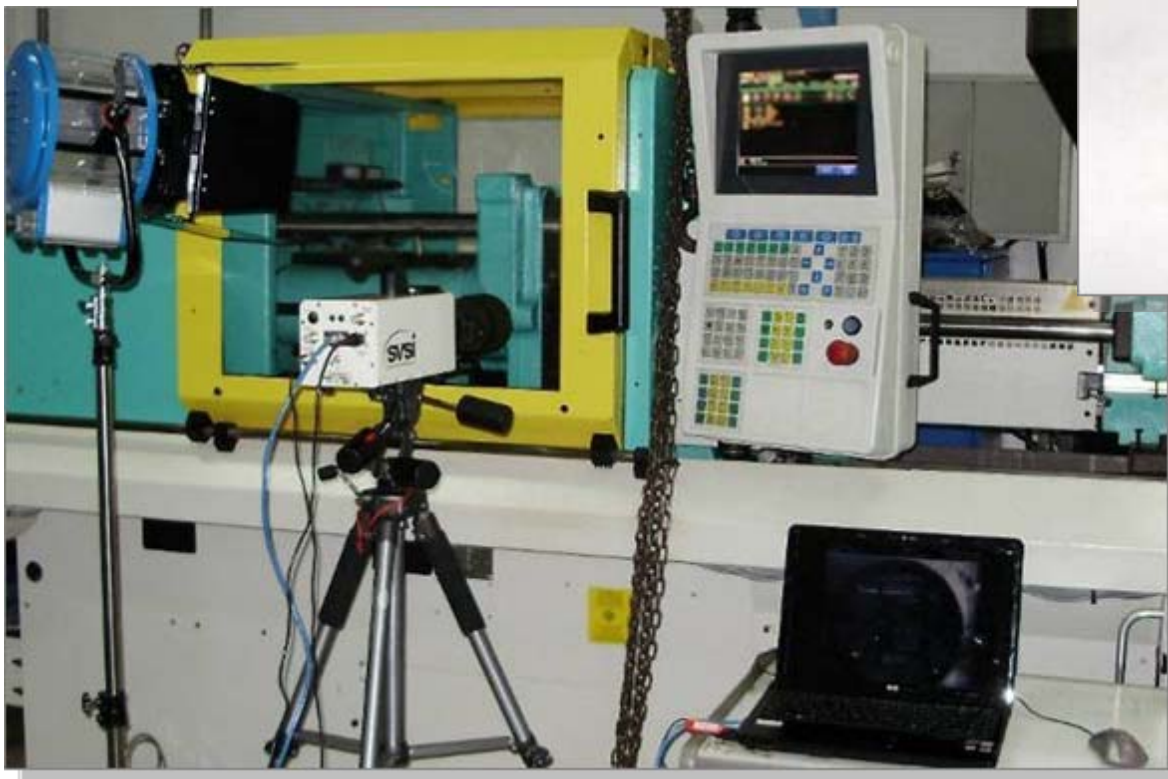
配备高速摄像机的精密注射充模过程可视化系统
