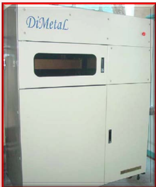
华南理工大学研发的选区激光熔化快速成型机
