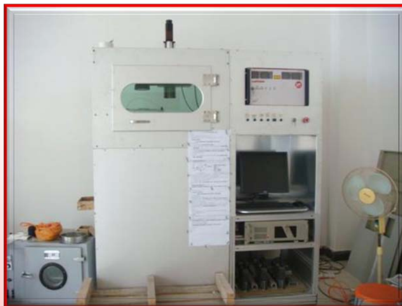
华南理工大学研发的选区激光熔化快速成型机
