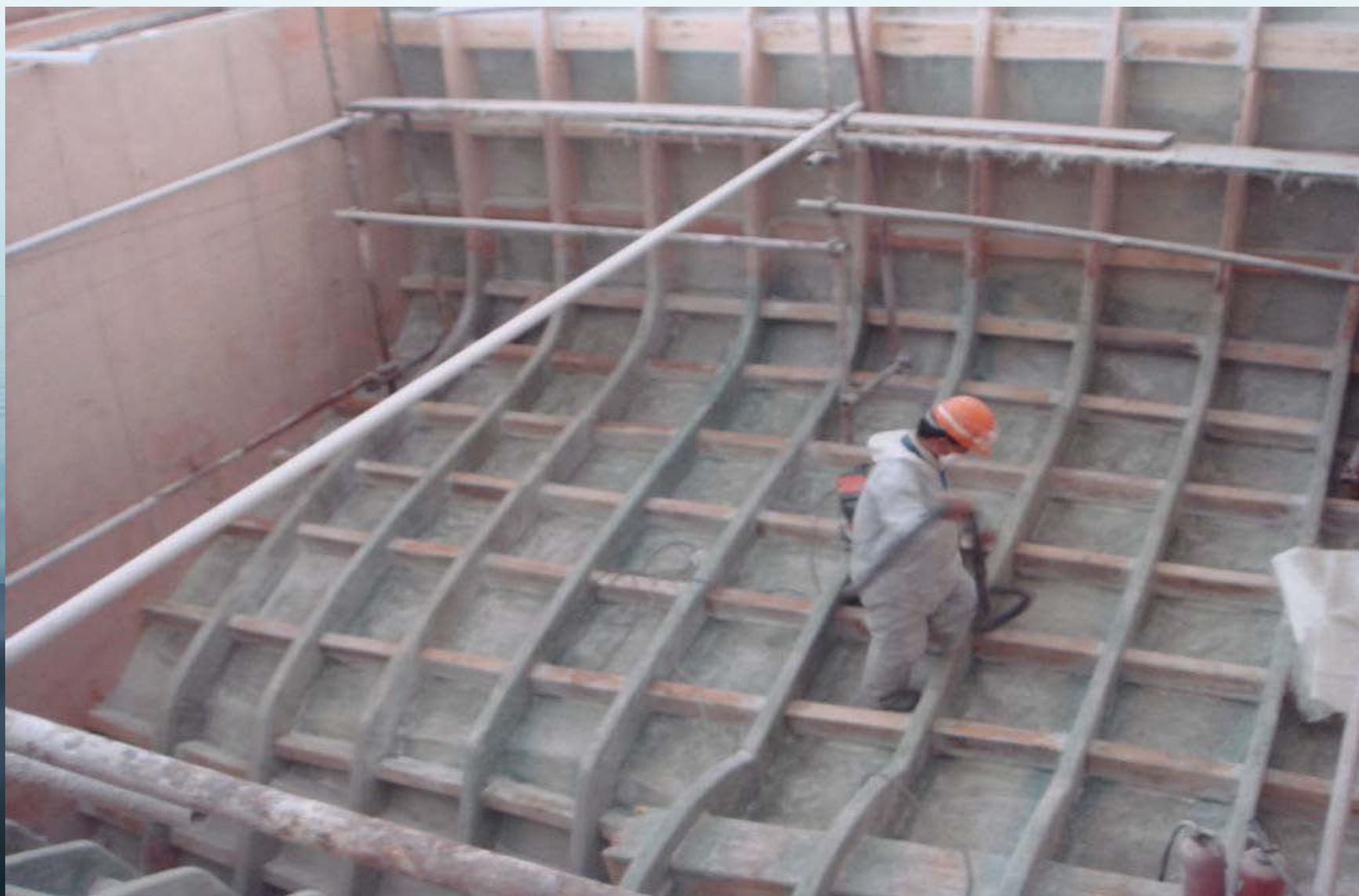
(10) 外表面打磨，平整度达到技术要求后，
