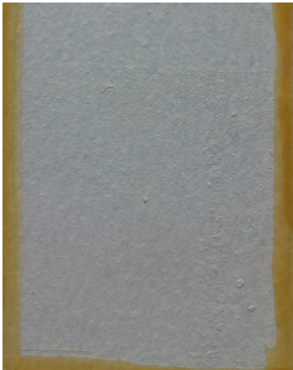
普通外墙涂料 144小时表面浸蚀后 (20% \text{H}_2\text{SO}_3 溶液) 表面起泡, 漆膜被破坏
