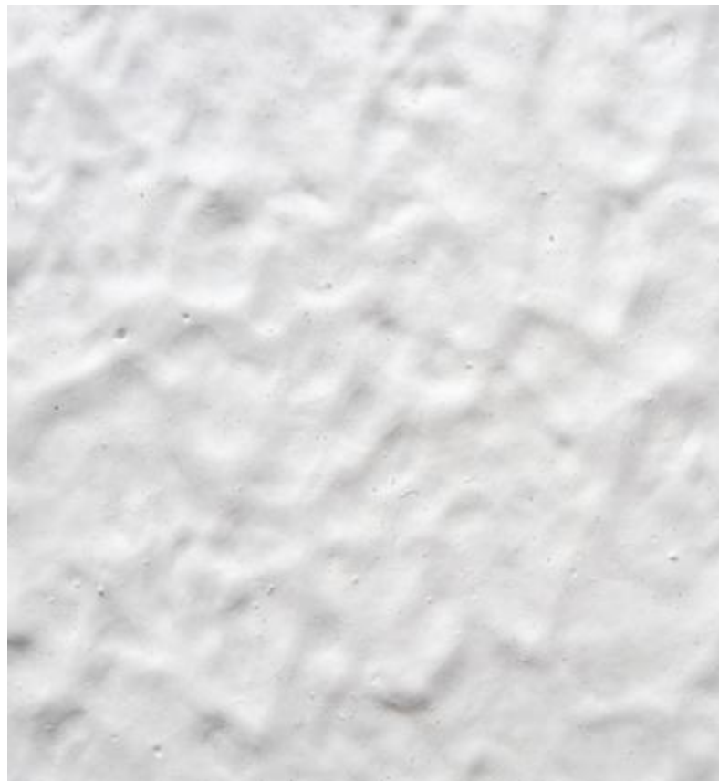
弹性中层拉花+老人牌双组分水性聚氨酯涂料 经过冷热循环测试后表面无开裂现象
