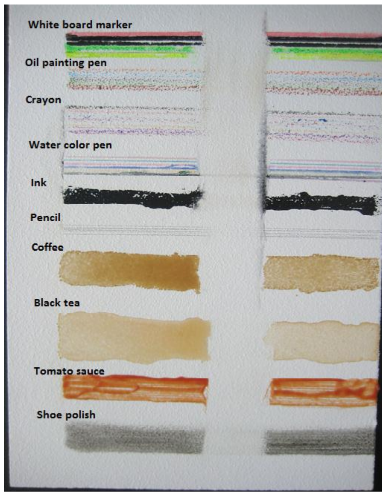
老人牌双组分水性聚氨酯涂料 5% 洗洁精溶液擦拭后
