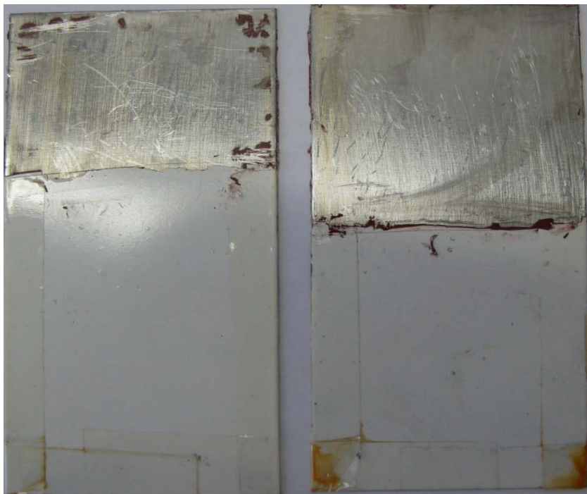
706防锈底漆 ( 40um ) 301铁红防锈底漆 ( 40um ) 醇酸面漆 ( 40um ) 301白色面漆 ( 40um )
