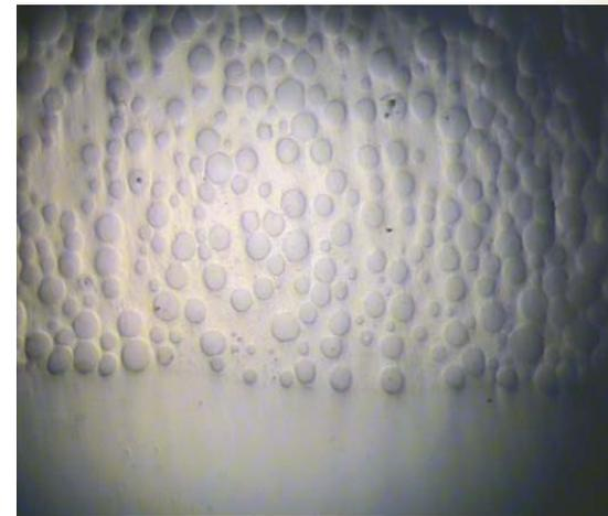
自主研发的激光器的激光熔覆层WC颗粒的分布情况
