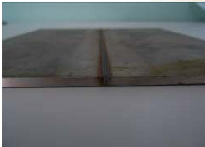
5mm厚不锈钢板的对拼焊
