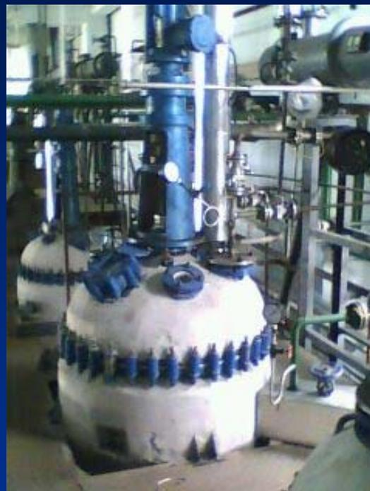
图2：长春高琦500L聚合釜中试线
