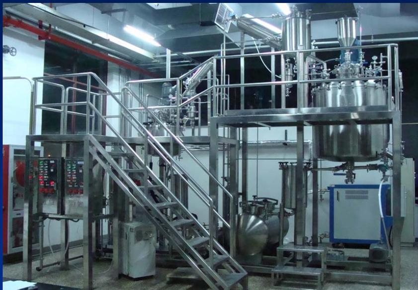
图1：宁波所50L聚合釜实验线
