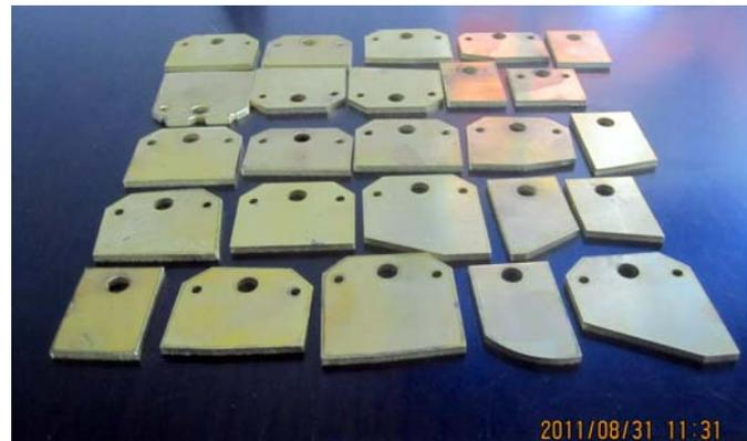
光纤激光器切割铜板
