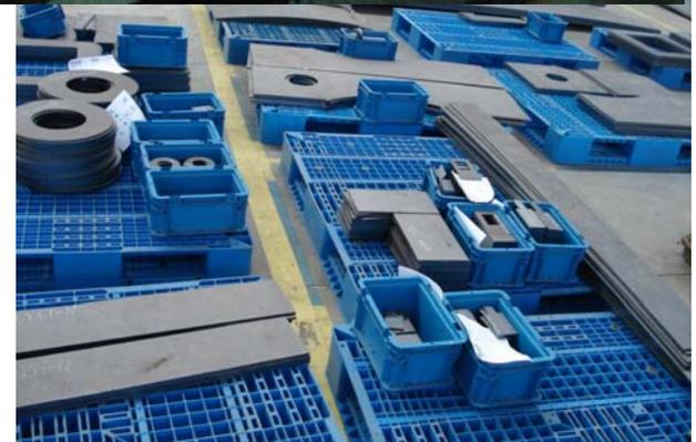
能用激光就不用等离子。能用等离子就不用火焰。截止目前， 已使用约80台激光切割机， 100多台等离子切割机。
