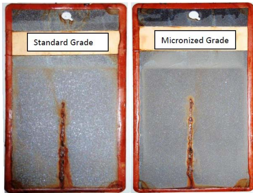
ISO 20340循环腐蚀试验.
