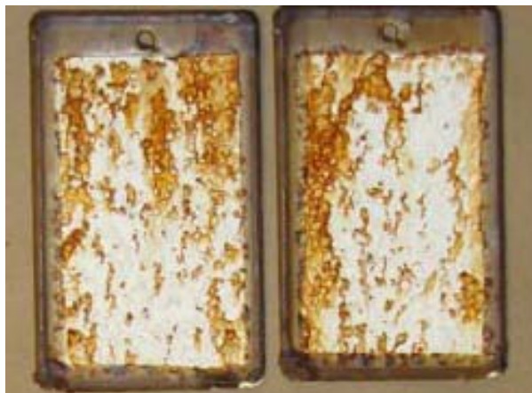
2% 有机缓蚀剂B 80 \mu m
