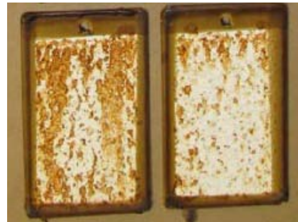
不含 有机缓蚀剂 125 \mu m
