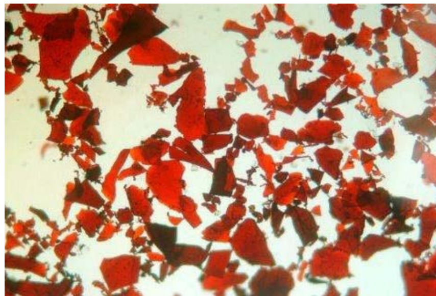
KMI公司IMO的光学显微镜图 98%小于40 \mu\text{m}
