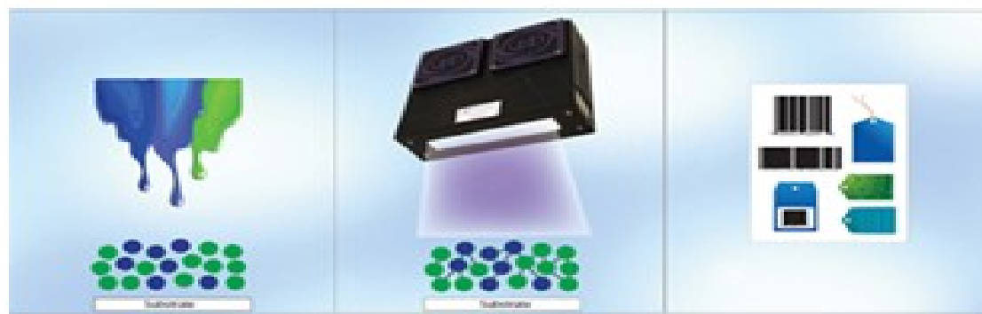
LED-UV 固化油墨与 LED-UV 固化涂料固化过程示意图
