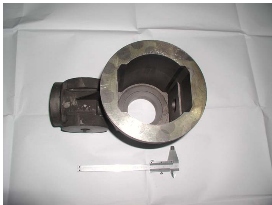
北京211厂钛钨铝零件的电火花高效加工
