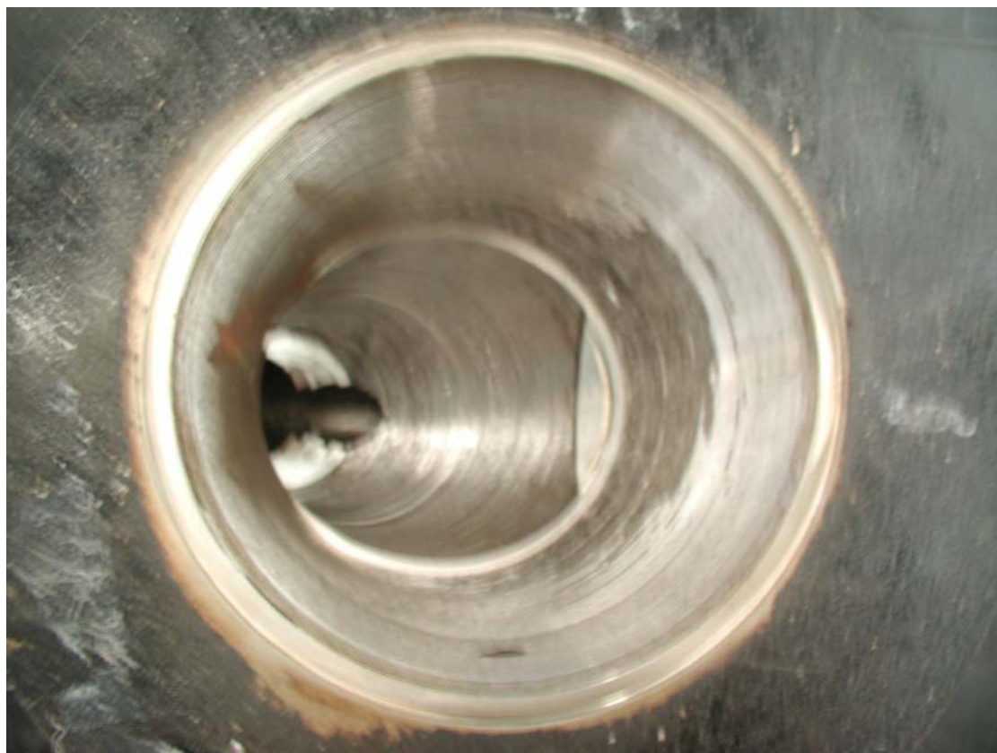
加工出的舰载装备零件的特殊变径环形通道
