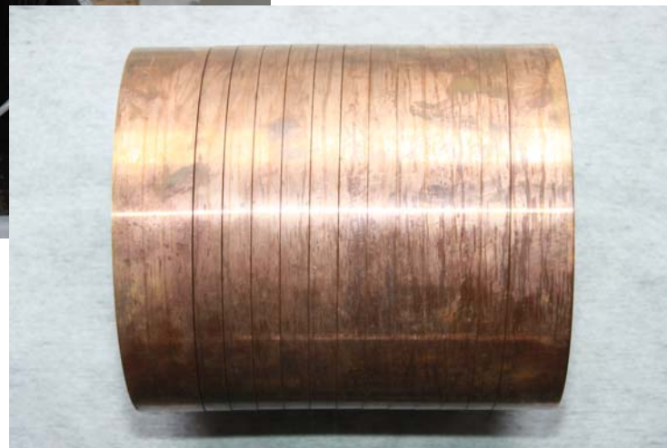
用精度A轴及X、Y、U、V轴联切割的螺旋槽
