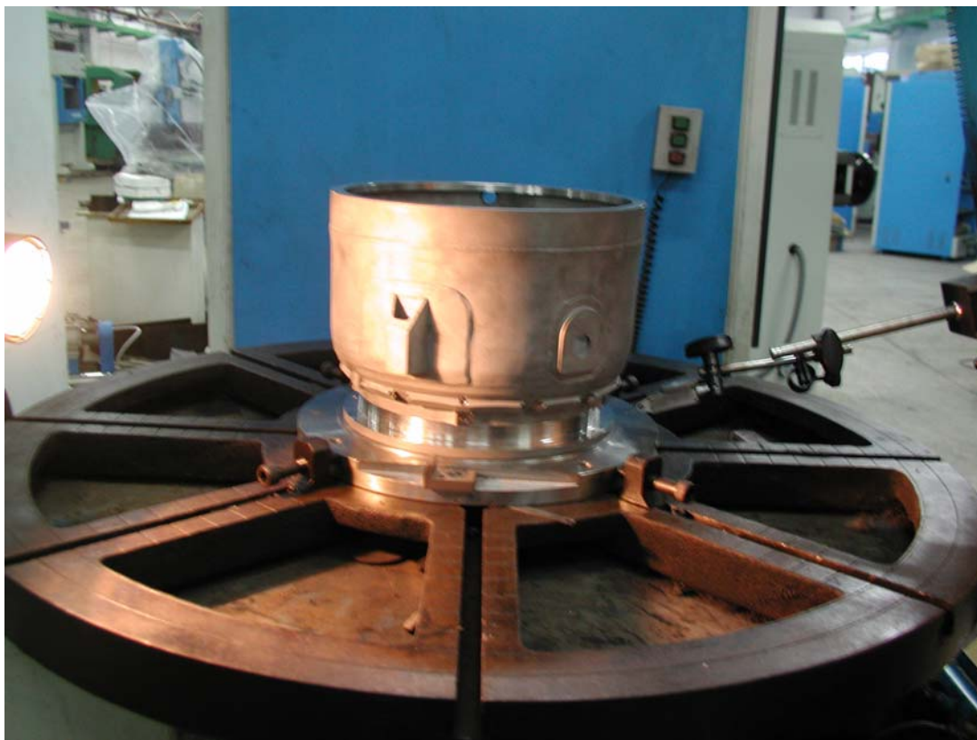
正在为成发加工发动机零件上的环状分布的月牙形槽
