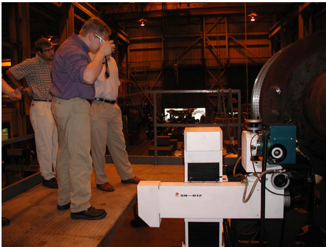
为美国GE公司研制的高效深孔电火花加工设备 正在加工燃气轮机上的特殊部位
