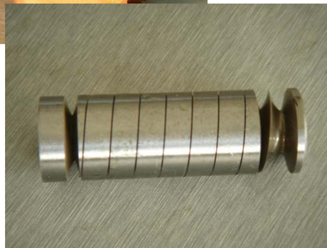
用精度A轴及X、Y、U、V轴联切割的复杂零件
