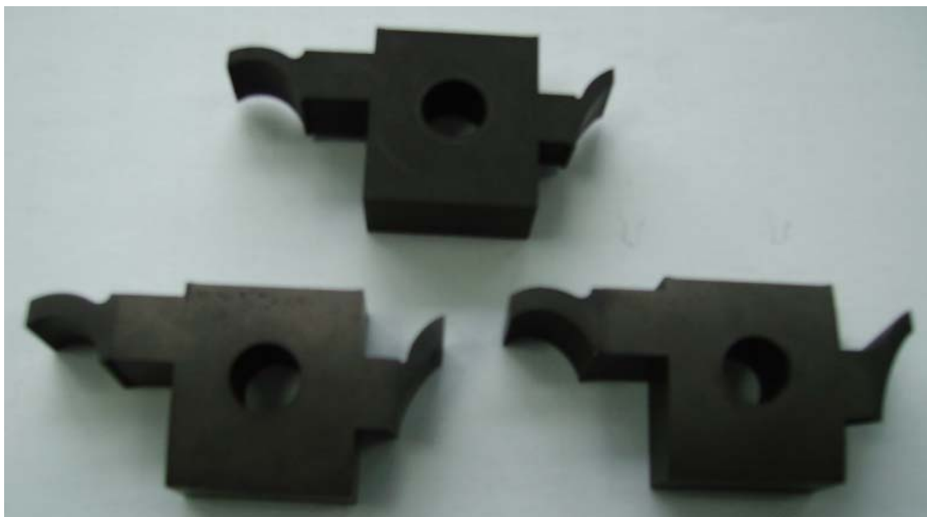
带冠扭曲叶形整体涡轮盘五轴联动电火花成形加工用电极
