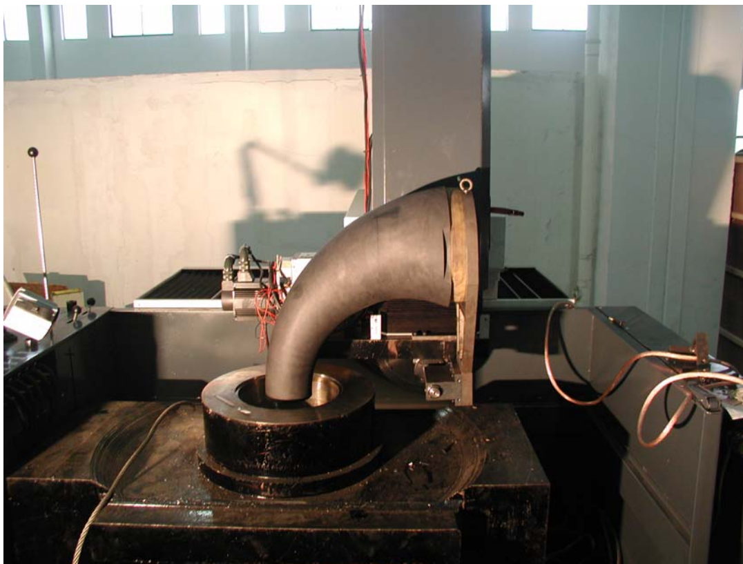
正在加工舰载装备零件上的特殊变径环形通道
