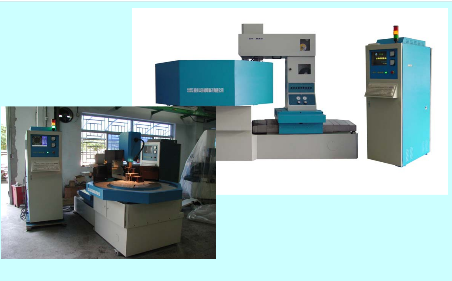
为成都艾特公司研制的环件数控电火花线切割机
