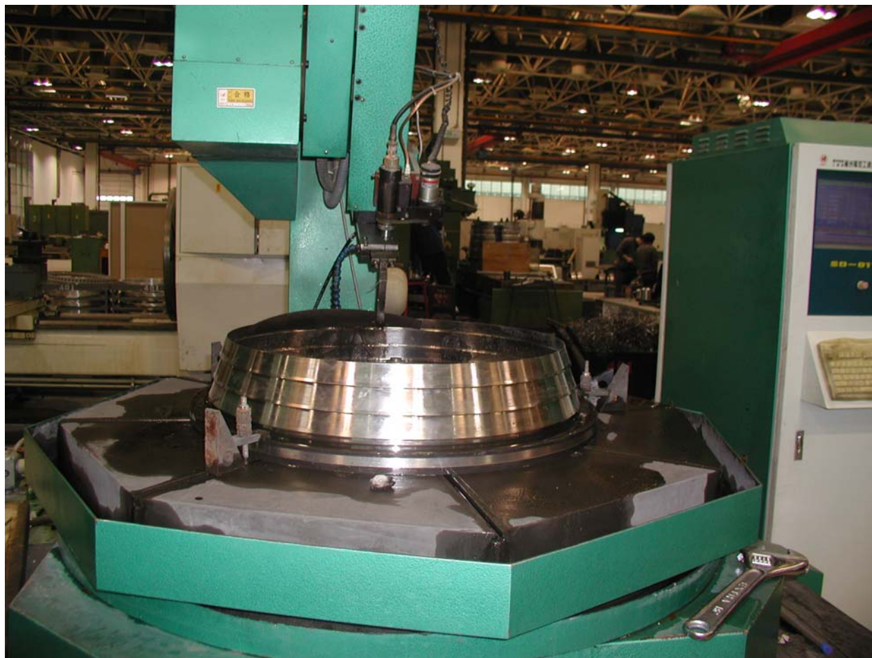
正在加工多层环件小孔
