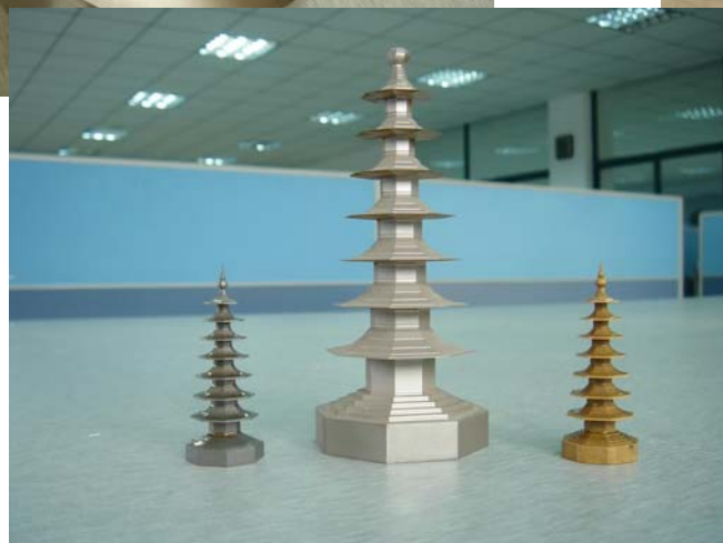
用精度A轴及X、Y、U、V轴联切割的复杂零件
