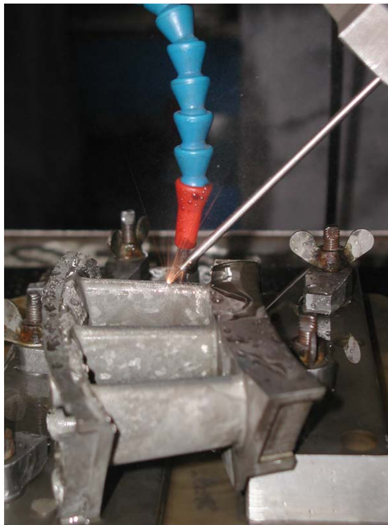
正在加工三联叶片上的小孔
