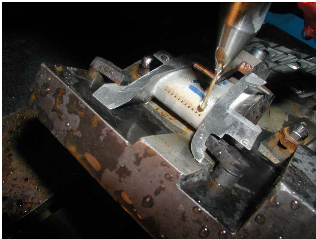
正在加工发动机叶片气膜孔
