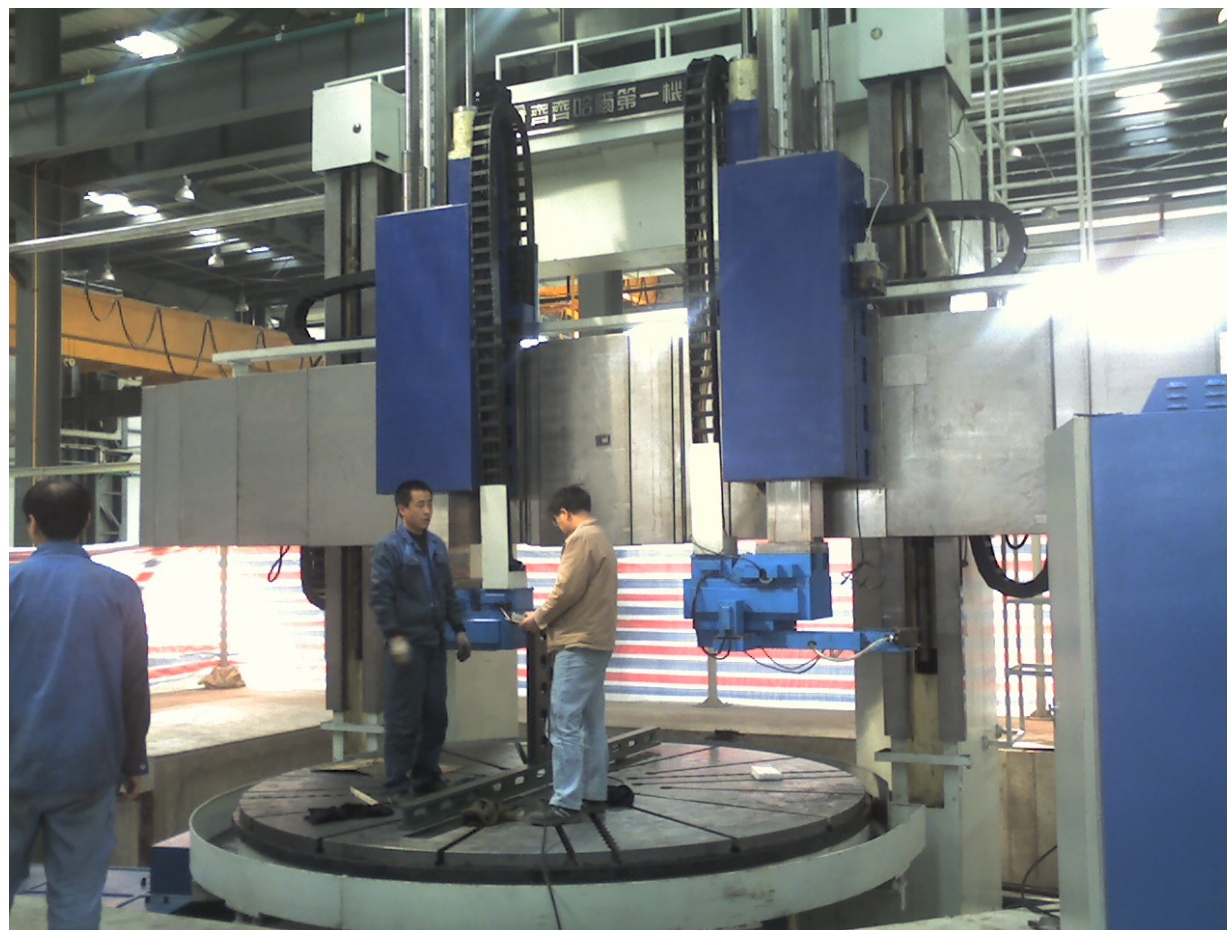
为沈阳黎明重型燃机项目研制的多轴数控大型3M蜂窝环电火花磨专用设备
