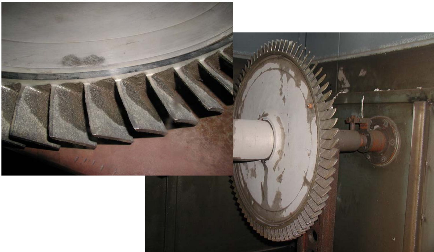
用数控高效放电铣加工的高温合金整件叶盘叶片
