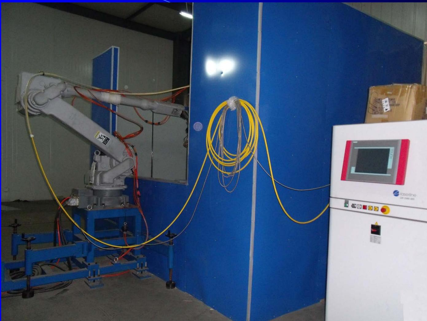
移动式半导体激光机器人多功能3D加工系统（在麓谷）
