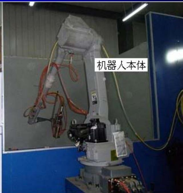
半导体激光器机器人加工系统（主要用于修复再制造）
