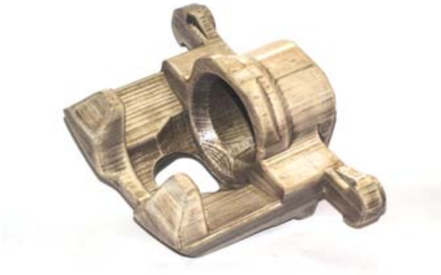
轿车刹车钳体精铸母模的 RP 原型（左）与精铸件（右）
