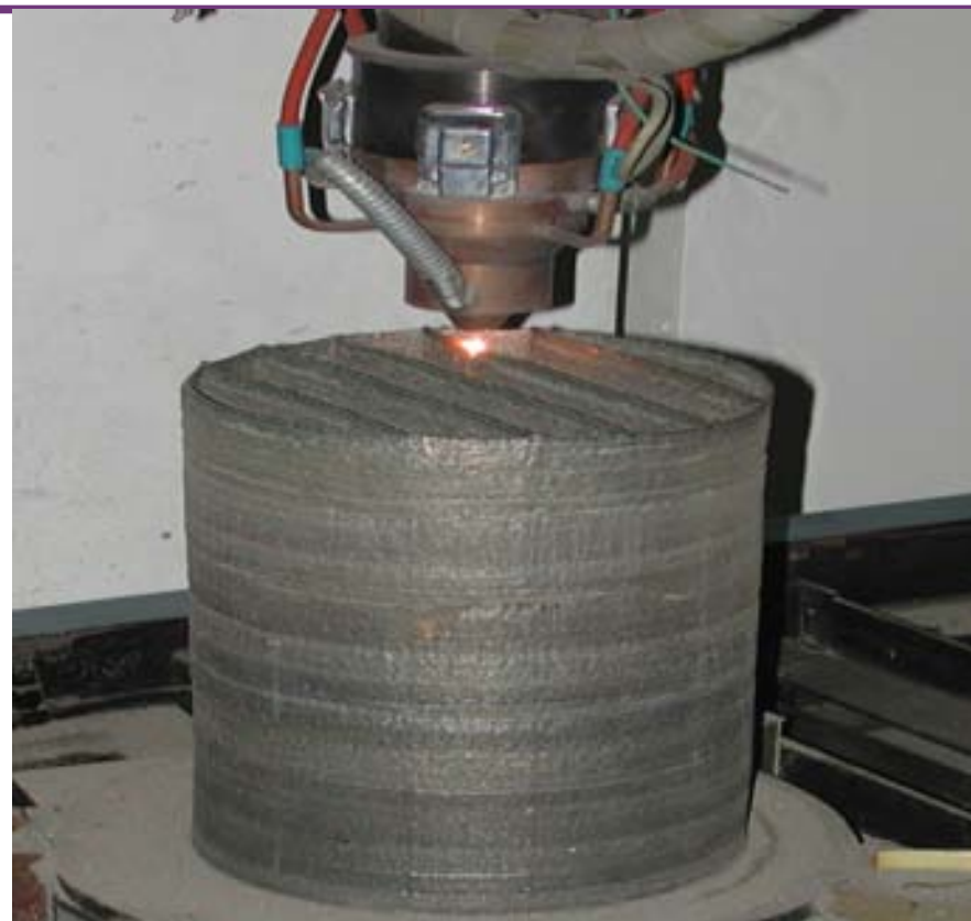
成形中的天体望远镜 镜钨基合金准直器
