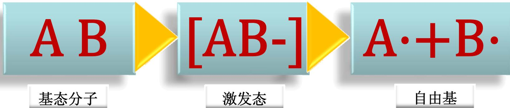
光引发剂吸收紫外光，发生激发，进而导致光引发剂分子断裂成自由基
