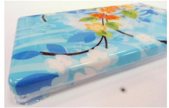
薄膜材料受熱(T)及壓力(P)活化/軟化
