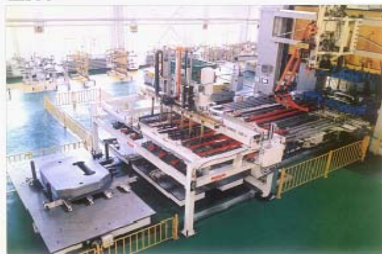
JIER为哈飞汽车提供的机械手自动化冲压线
