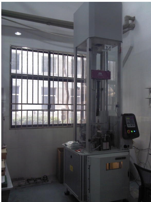
Instron 示波冲击试验机 (最大冲击能量1800J, 最大冲击速度24m/s)
