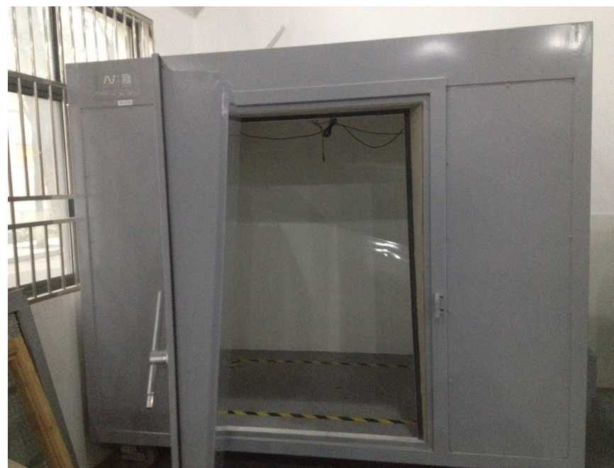
混响室（测定材料声学性能）
