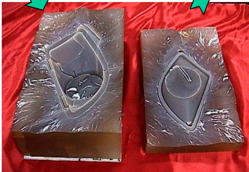
汽车灯具 LOM 原型件、硅橡胶软模 及高分子材料制件
