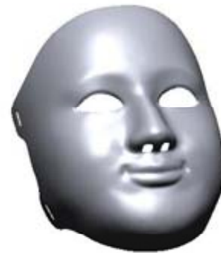
图3 逆向重构后的乳胶模具——脸
