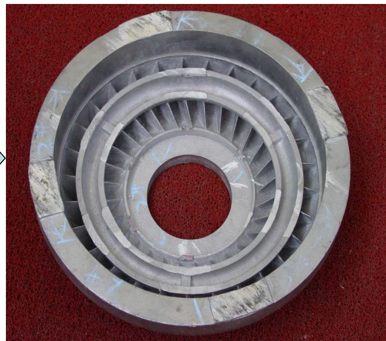
φ460mm涡轮铸件
