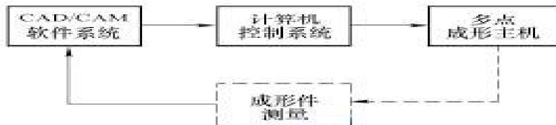
图2 无模多点成形设备的主要构成
